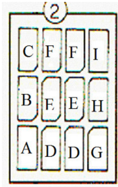
चित्र 12.8: ए.सी. चादरों को किछाने का तरीका
