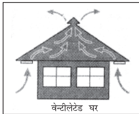
चित्र 31.2: वेन्च्यूरा प्रणाली उच्च एवं कम दाब का प्रयोग ठंडी हवा को खींचता है एवं रूफ वेन्टीलेटर के द्वारा गर्म वायु को बाहर निकालता है
