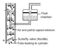
Fig. 9.36 : Carburettor
