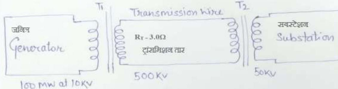
ट्रांसफार्मर T2 सबस्टेशन पर वोल्टेज को 50 KV AC तक नीचे ले जाता है। यदि दोनों ट्रांसफॉर्मर आदर्श होते हैं और ट्रांसमिशन लाइनों में धारा 200 A है संचरण के दौरान बिजली की हानि कितनी है ?
